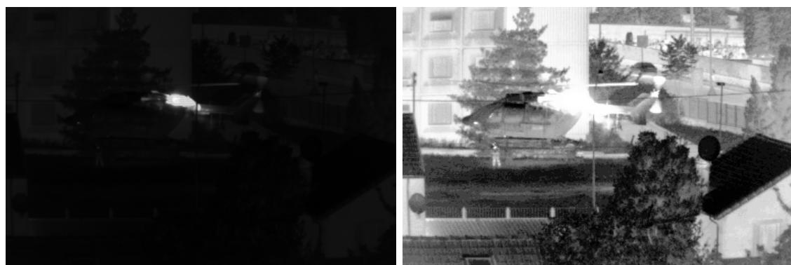
FIG. 1.4 – A gauche, une image infrarouge d'un hélicoptère au décollage, après avoir effectué un ajustement linéaire. A droite, la même image ayant subi une égalisation d'histogramme.
